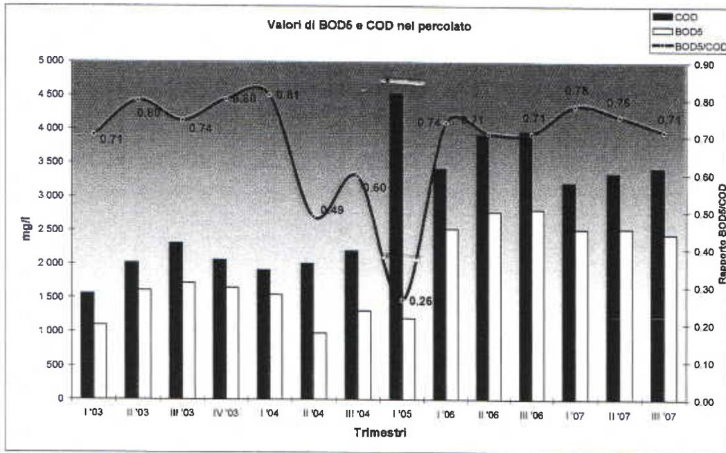
Come evidenzia il grafico nei mesi di gennaio si osserva un aumento del COD in relazione a una diminuzione delle precipitazioni e delle relative infiltrazioni nel corpo rifiuti.
