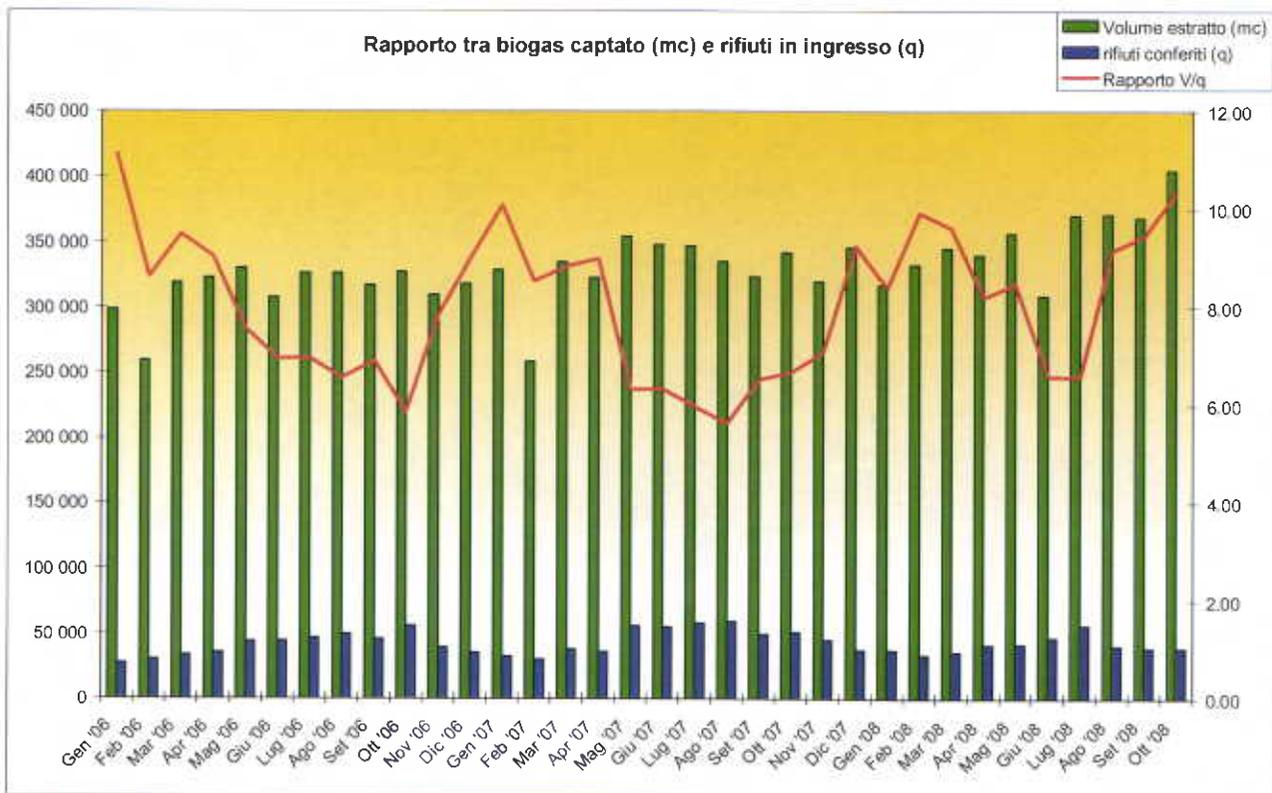
I volumi di biogas estratti vengono monitorati quantitativamente e qualitativamente da ASJA; ASA effettua mensilmente mediante laboratori esterni il monitoraggio della qualità del biogas in corrispondenza della stazione di aspirazione:
