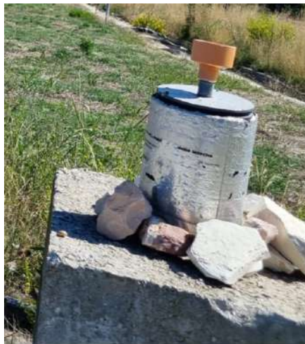
Figura 4 – Fotografie della stazione di campionamento acque meteoriche UNIVPM
