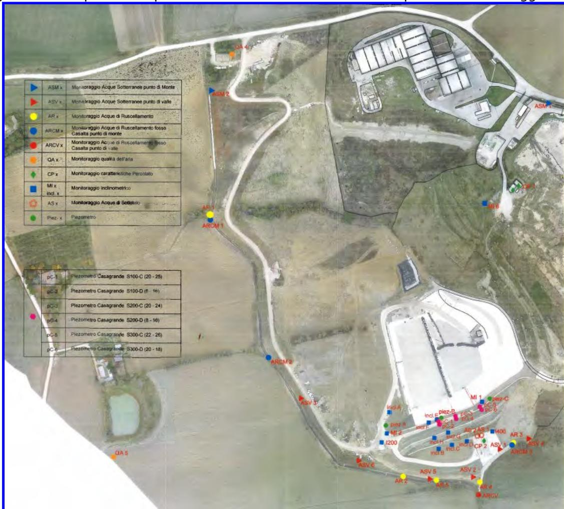
Ubicazione strumentazione di monitoraggio
