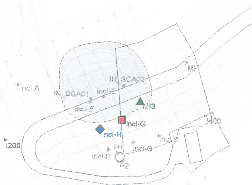
Figura 19 – Inclinatori selezionati per il monitoraggio dell'argine durante il riempimento della discarica
