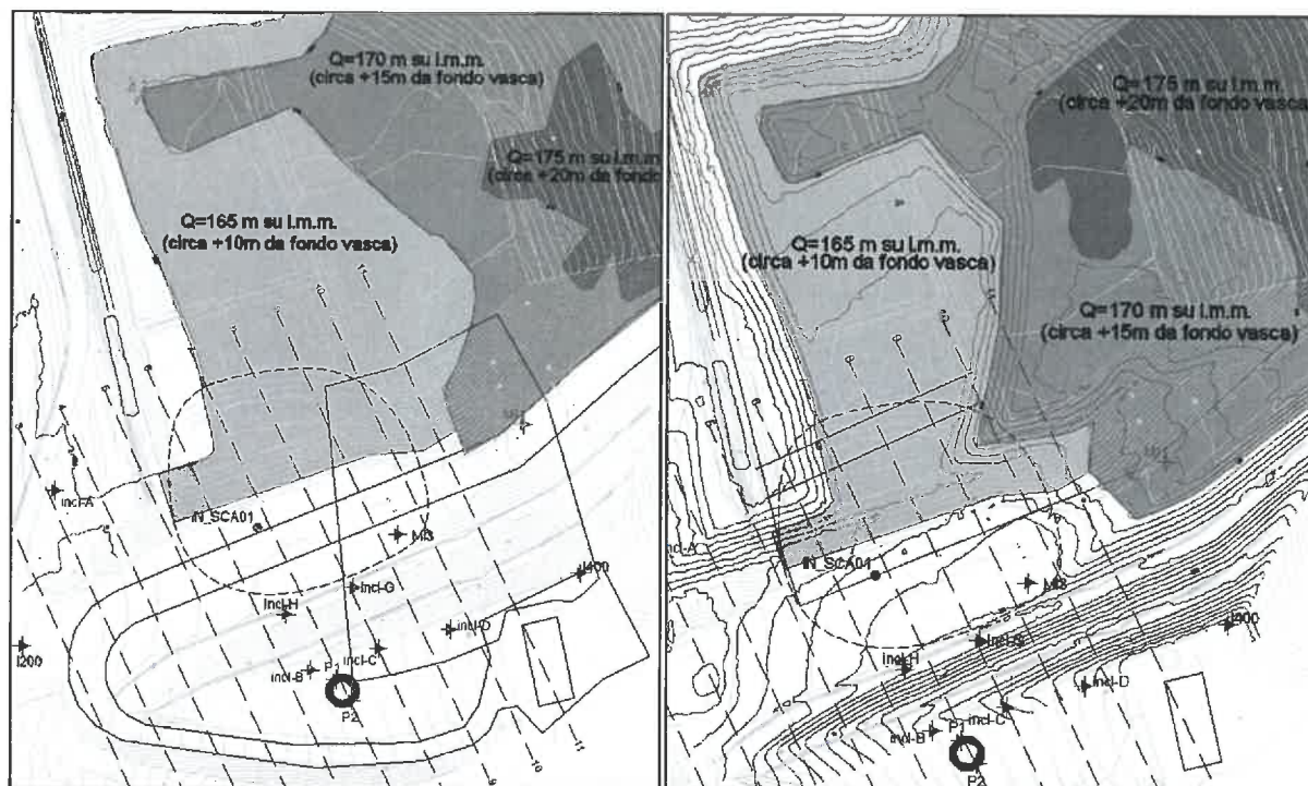
Figura 6 – Rilievo plano-altimetrico della discarica al 24-05-2020 (a sx) e al 6-09-2020 (a dx)
