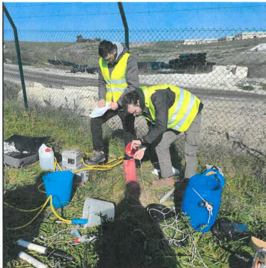
Figura 3 – Immissione di tracciante in un piezometro per lo studio della circolazione idrica sotterranea dell'area (foto 31-1-2023)
