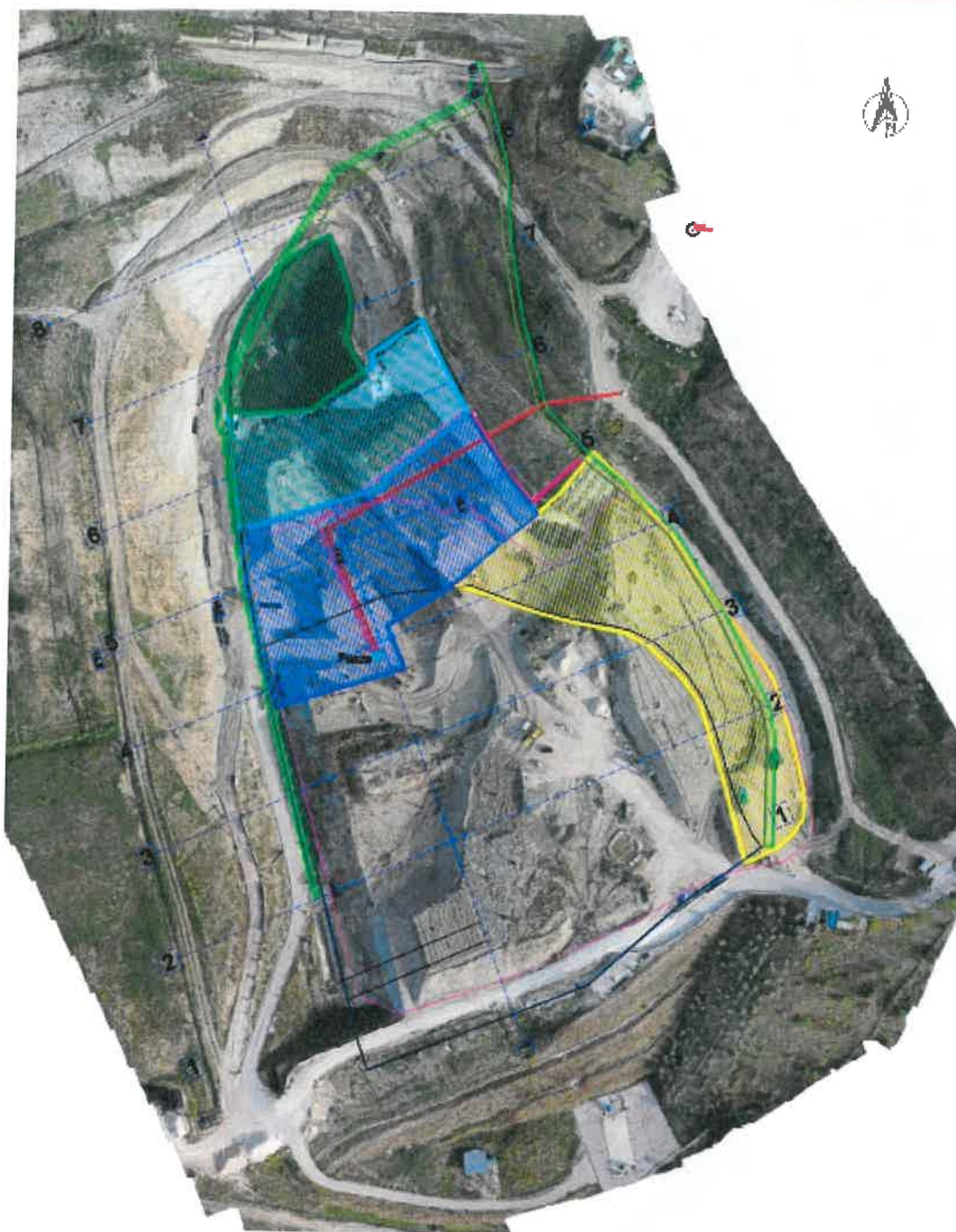
Veduta aerea del 1° lotto dell'ampliamento con individuazione delle aree collaudate del 2° stralcio: porzione 1 parte funzionale (in giallo, luglio 2020), porzione 2 e 3 parte funzionale (in blu, dicembre 2020), ulteriore porzione della 2 e 3 parte funzionale (in celeste, aprile 2021) e ulteriore porzione della 2 e 3 parte funzionale (in verde, ottobre 2021)
