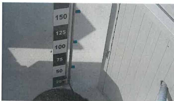
Visuale dell'asta graduata dallo smartphone attraverso l'applicazione XMEye
